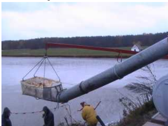
Hubarm aus Heugebläse-Rohre
